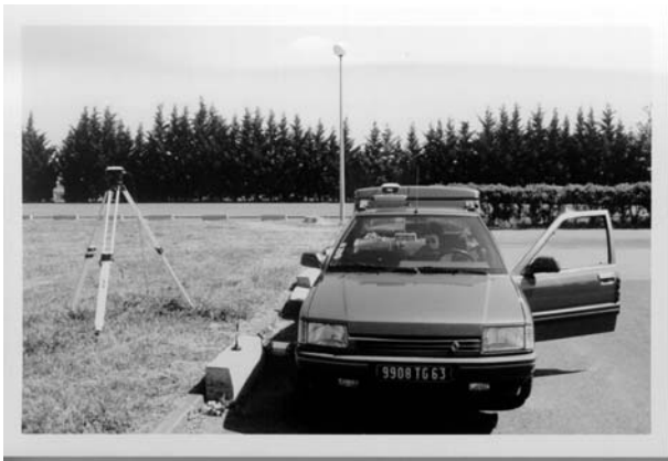
FIG. 3.6 – Evaluation d'un système GPS cinématique
