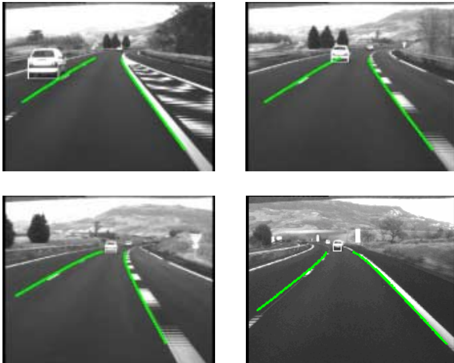
FIG. 3.16 – Résultats de suivi d'un véhicule «blanc» sur une séquence d'images.
