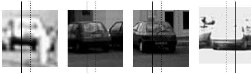
FIG. 2.23 – Exemples d’imagettes où l’estimation de l’axe de symétrie est la plus «biaisée» : la ligne pleine représente l’axe estimé et la ligne en pointillée l’axe de symétrie selon l’initialisation «utilisateur» de l’imagette.
