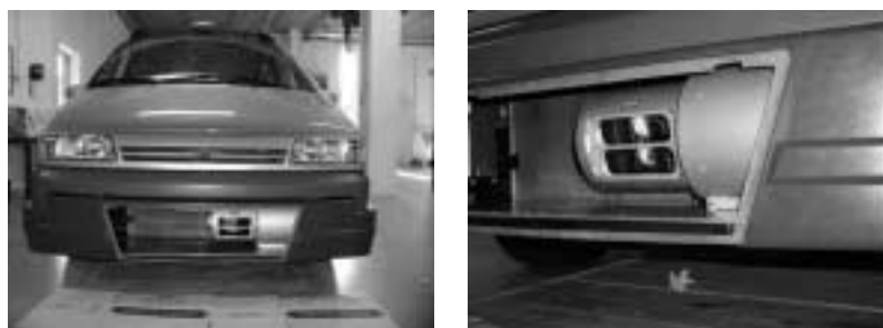
FIG. 1.12 – Vues du capteur IRDAR embarqué dans le véhicule VELAC.
