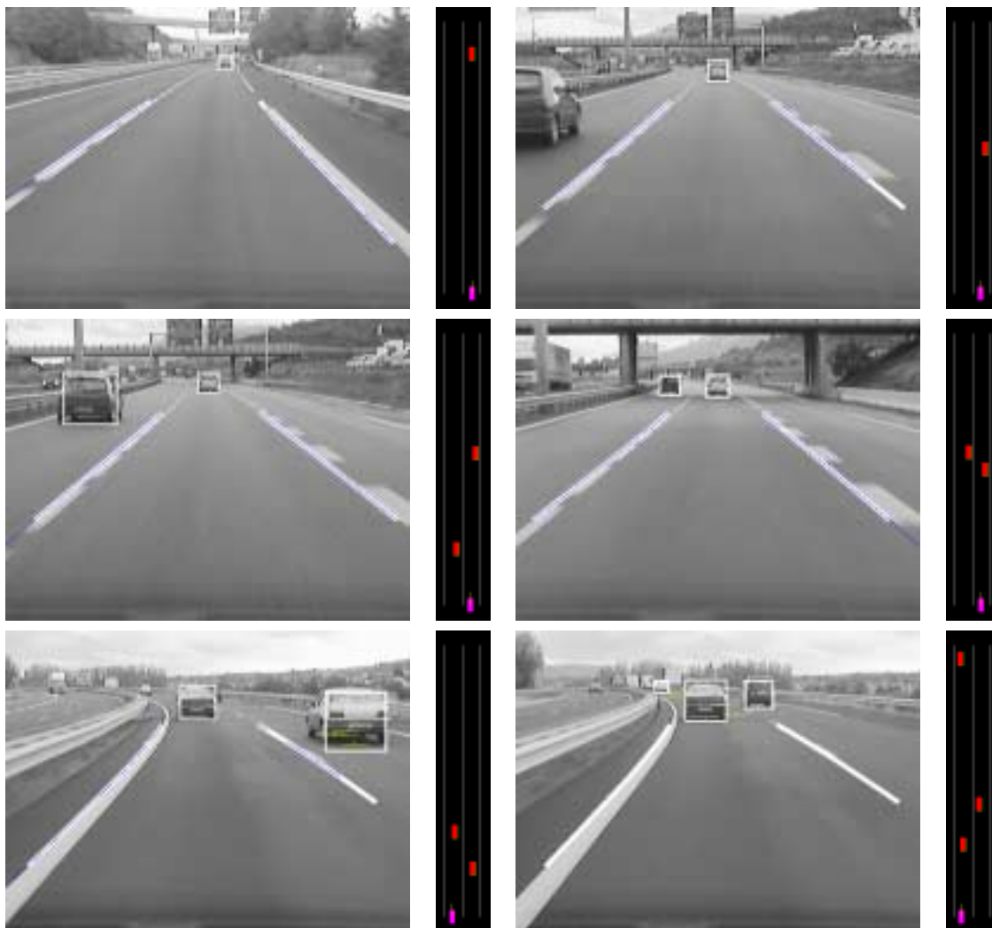
FIG. 2.26 – Exemples de détection de véhicule. À gauche, les rectangles blancs représentent les véhicules détectés. À droite, les véhicules détectés et le véhicule VELAC (en bas) sont localisés par rapport aux voies de circulation (entre 0 et 100m ).
