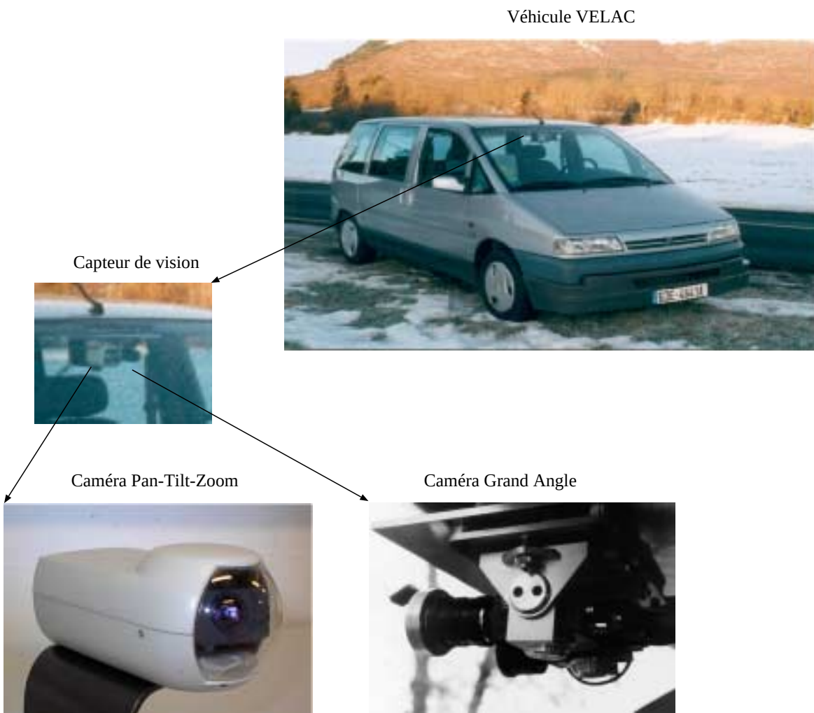
FIG. 4.17 – Capteur de vision embarqué dans le véhicule VELAC.
