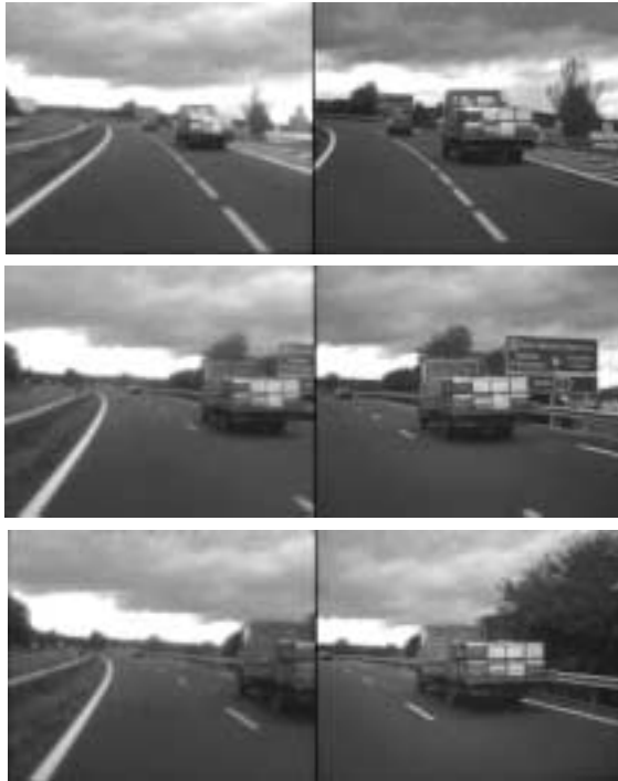
FIG. 4.20 – Extraits de séquences de suivi d'un «camion» avec la caméra PTZ.
