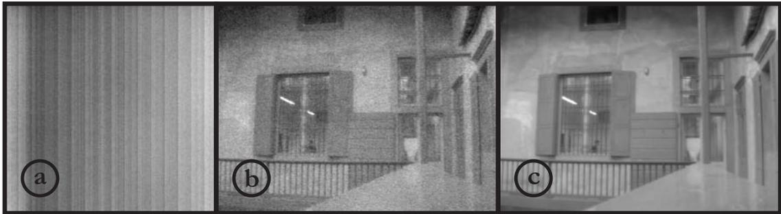
FIG. 2.14 – (a) - Bruit spatial fixe colonne important du à la présence d’amplificateurs colonnes (Fuga 1000 - Fill Factory), (b) - Image sans correction du bruit spatial fixe (NC1802 - Neuricam), (c) - Image après correction du bruit spatial fixe (NC1802 - Neuricam).
