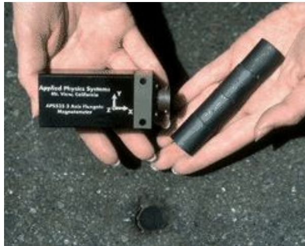
FIG. 1.10 – Balise magnétique utilisée dans le programme PATH
