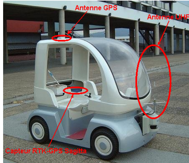
FIG. 4.5 – Implantation du capteur RTK-GPS sur Cycab
