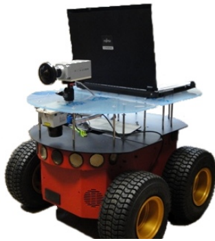
FIGURE 1.1 – Pioneer : robot quadricycles développé par Adept MobileRobots
