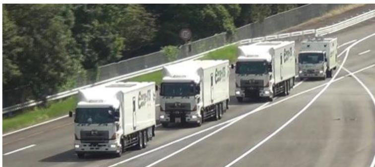
FIGURE 1.27: Un convoi de 3 camions lourds et un camion léger dans le cadre de "Energy ITS"
