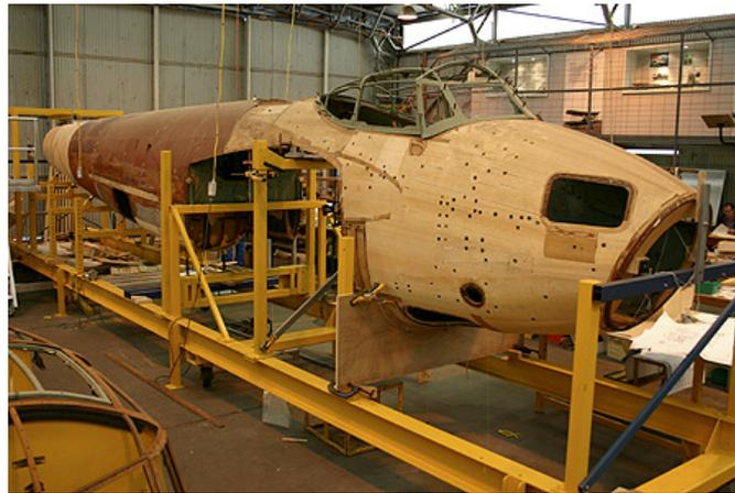
FIGURE 1.10 – Châssis d'avion en bois.
