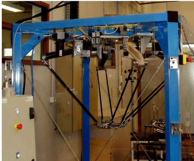
(b) Bras en bois monté sur le prototype
