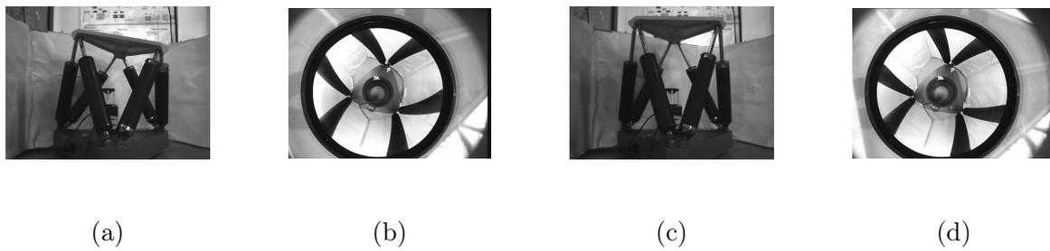
FIG. 3.12 – Exemple de résultat de commande par vision de la plateforme de Gough-Stewart : (a) et (b) configuration et image initiales, (c) et (d) configuration et image désirées.
