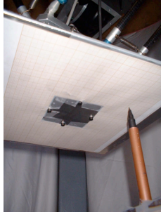
FIG. 12 – Plaque et stylet permettant le tracé de la trajectoire.
