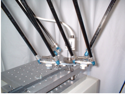
FIG. 9 – Validation de l'identification par contrainte cinématique sur l'effecteur - Configuration 1.
