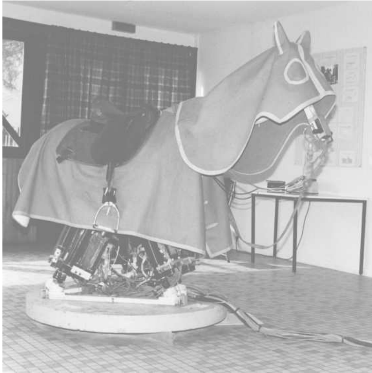
Figure 2.41: Simulateur équestre «Persival» de l'École Nationale d'Équitation construit en collaboration avec l'ENAC (photographie E.N.E.).
