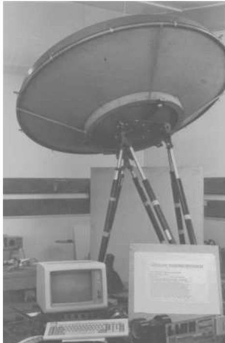
Figure 2.38: Un exemple d'utilisation d'un manipulateur parallèle pour la commande de l'orientation des antennes. A noter la faible dimension des actionneurs par rapport à la taille de la parabole.
