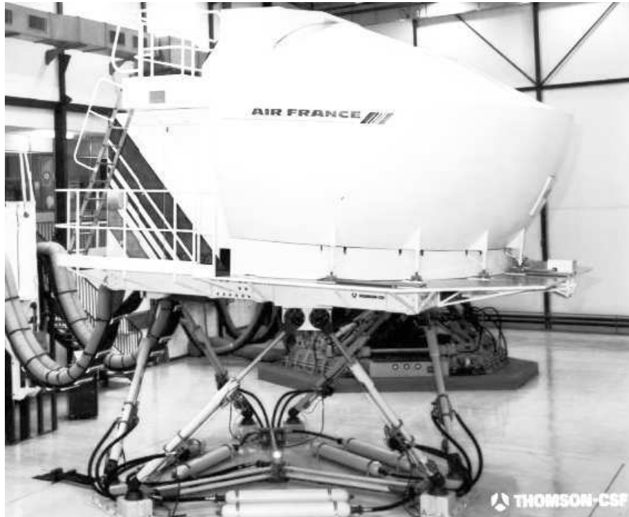
Figure 2.40: Le simulateur de l'Airbus A340 (réalisation THOMSON-CSF, photographe P. Palomba).
