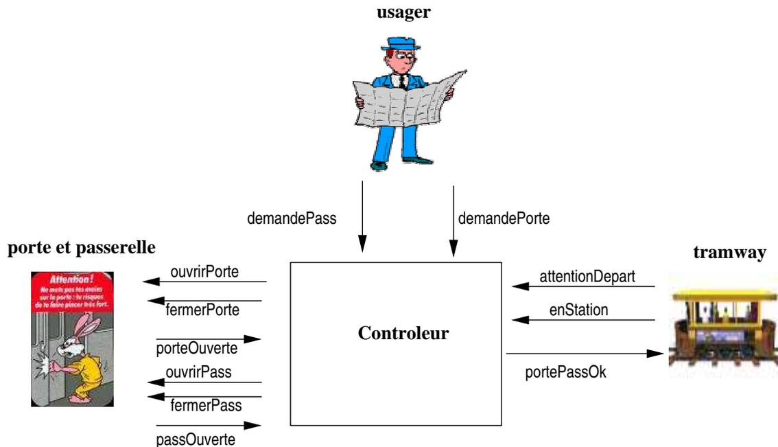
FIG. 2 – Le contrôleur de porte de tramway
