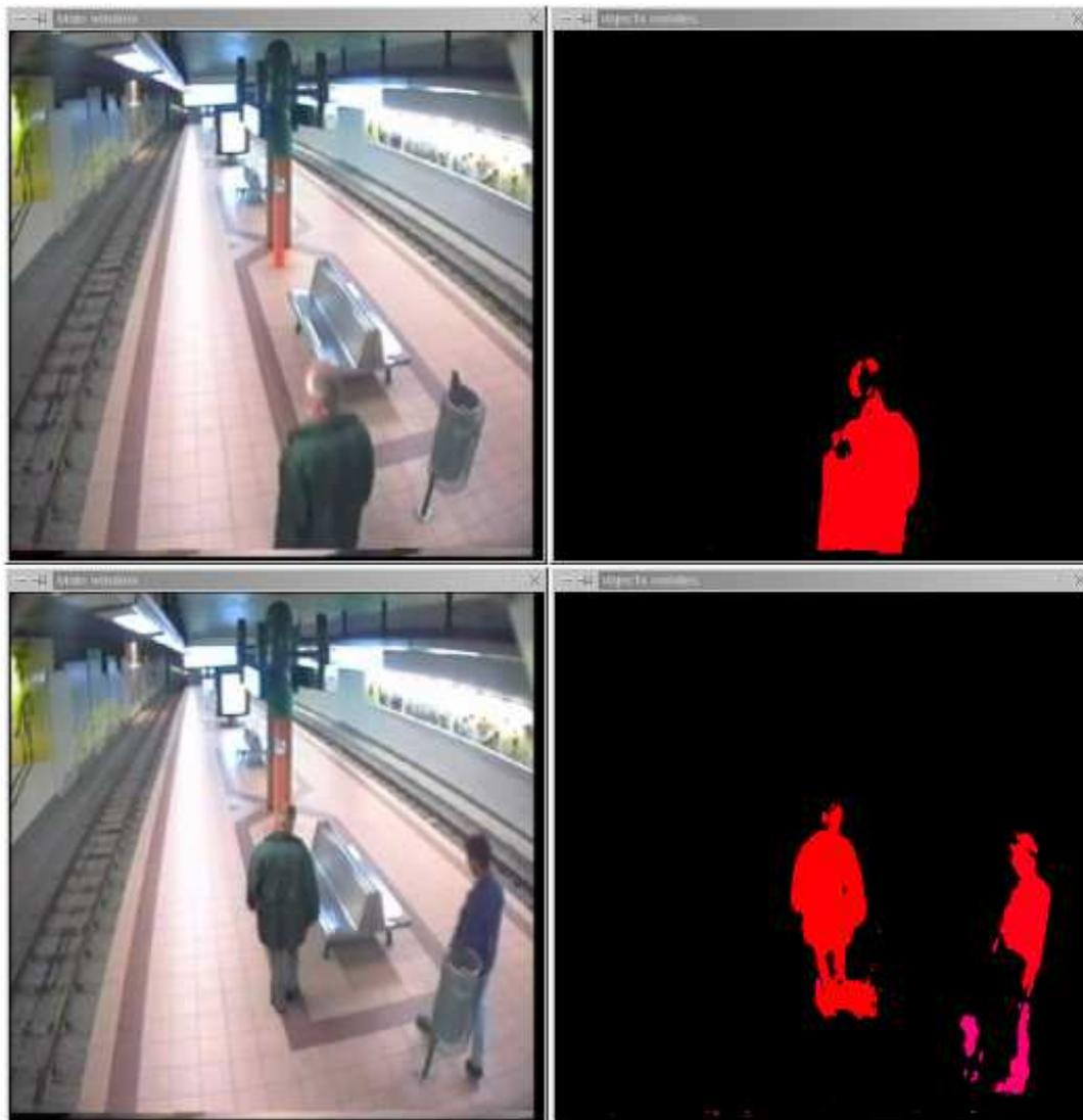
Figura 5.4: Le due immagini in alto mostrano un esempio di occultazione dovuta ai limiti di campo di visione della videocamera. Le due immagini in basso un esempio di occultazione dovuto ad un oggetto dell'arredo (un cestino dei rifiuti).
