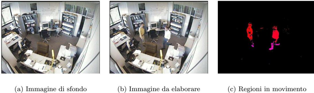
Figura 3.4: La figura mostra le regioni in movimento (c) ottenute dall’algoritmo di segmentazione, elaborando l’immagine (b) ed utilizzando come immagine di riferimento l’immagine (a).
