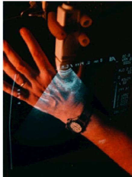
FIG. 1.8 – *Visualisation d'une coupe échographique dans le champ visuel de l'utilisateur à l'aide d'un miroir semi-transparent lié à l'échographe [SSC<sup>+</sup> 02, SCHB01]. A gauche : le Sonic Flashlight<sup>TM</sup>. A droite : illustration de la vue fournie à l'utilisateur. La coupe de la main, acquise par l'échographe, est réfléchié par le miroir semi-transparent dans le champ visuel de l'utilisateur.*
