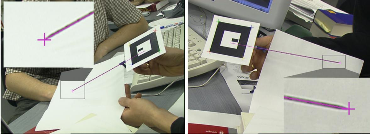
FIG. 5.16 – *Validation visuelle de la précision du recalage de l'aiguille virtuelle sur l'aiguille réelle. La croix dans les images correspond à la position virtuelle de la pointe de l'aiguille, et la droite à son orientation. Les zones encadrées ont été agrandies pour une meilleure vérification visuelle.*
