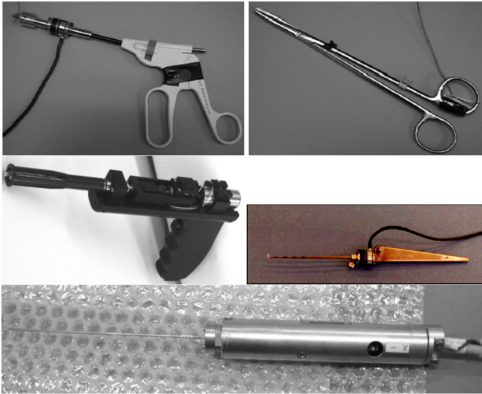
FIG. 1.9 – Outils utilisés pour les mesures rhéologiques in vivo dans [Brouwer et al., 2001] (haut), [Carter, 1998] (Milieu gauche) [Ward et al., 1999] (Milieu droit), et [Kataoka et al., 2002] (Bas).
