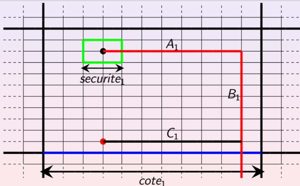
$$\frac{A_1+B_1}{vitesse_0} < C_1 - \frac{securite_1}{2} \quad \& \quad temps_1 = \frac{A_1+B_1}{vitesse_0}.$$
