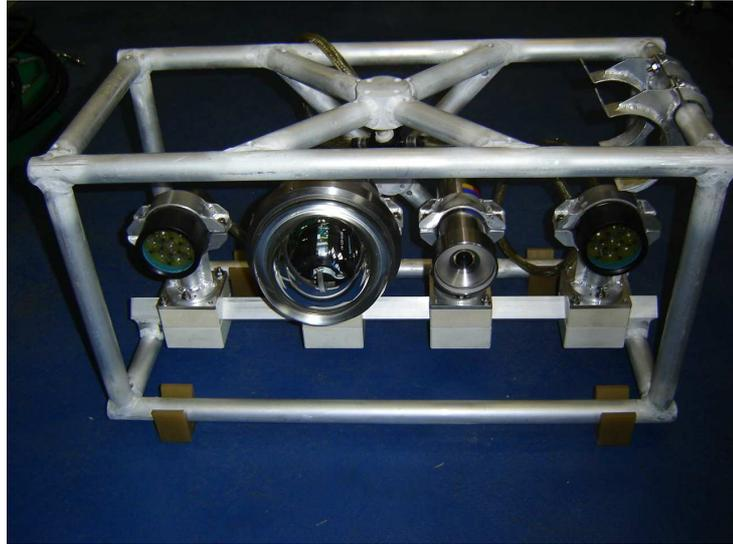
FIG. 2.26 – Tête stéréo IRIS composée d’une caméra mobile, d’une caméra fixe, de deux projecteurs à LED, et d’une boîte de jonction (absente sur la photo en haut à droite). La structure en aluminium fait 710 mm de largeur, 479 mm de hauteur, et 350 mm de profondeur.
