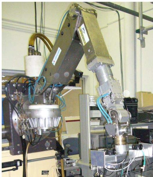
(b) Bras manipulateur hydraulique 6 d.d.l
