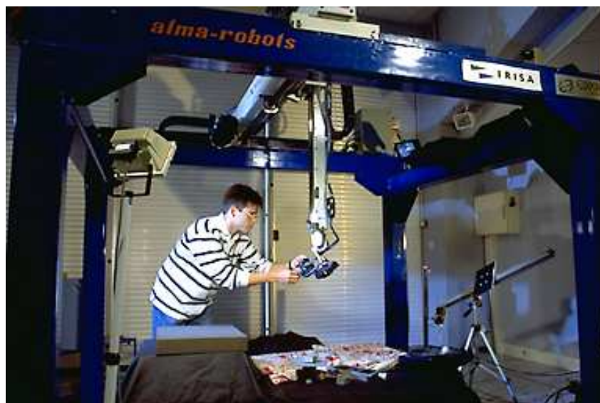
Figure 7.7 – Le robot Cartésien à 6 degrés de liberté de l'équipe LAGADIC de l'IRISA
