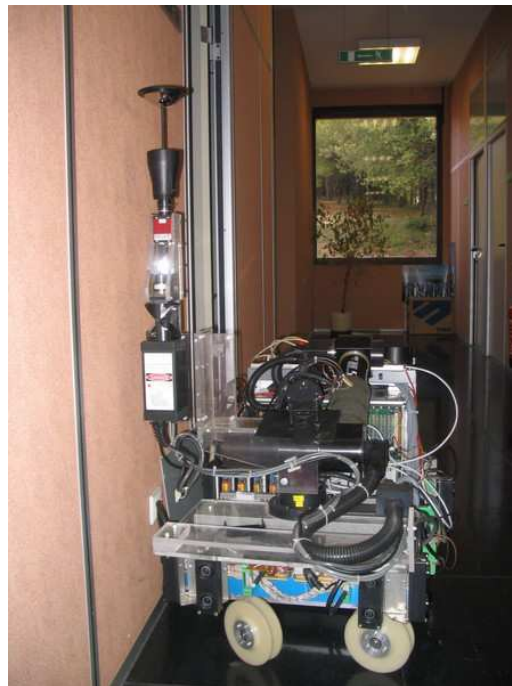
FIG. 5.5 – Photographie du robot ANIS — On peut voir les deux roues avant (roues folles en plastique avec une surface de contact très faible) ainsi que le montage vertical de la caméra omnidirectionnelle.
