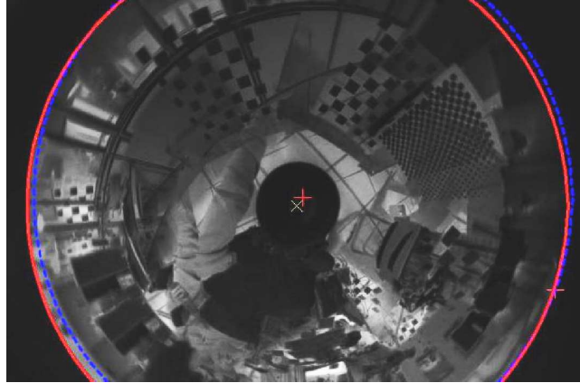
Figure 8: Extraction de la bordure du miroir pour estimer le point principal
