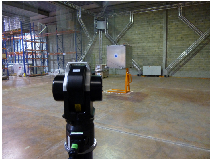
FIG. 4.1 – Tête du laser tracker
