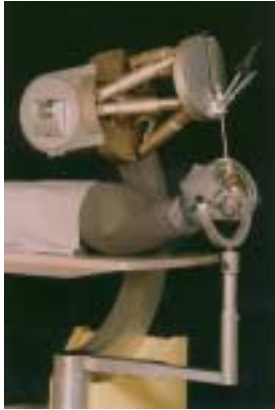
3.18 Prototype de robot parallèle hexapodal
