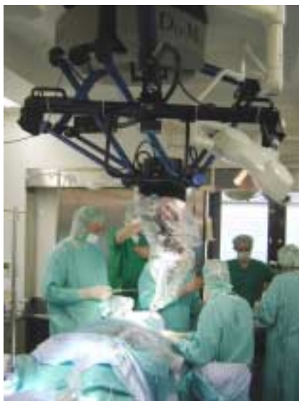
3.12 microscope robotisé : le SurgiScope™
