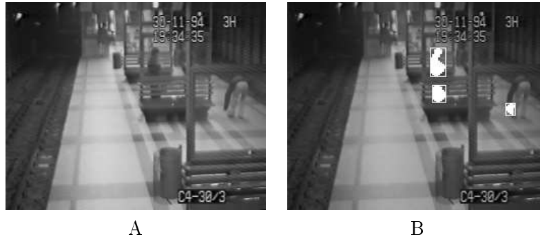
FIG. 2.2 – L'image A est l'image courante et représente la donnée d'entrée du système. L'image B contient les régions mobiles détectées par le module de détection. Les deux régions du centre correspondent à la perception d'un individu occulté par le dossier d'un banc.
