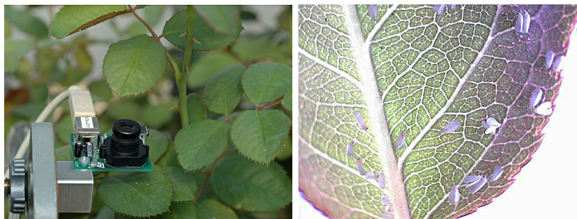
FIG. 2 – Premier essai de capture vidéo à l'aide d'un capteur CMOS positionnée sous une feuille de rosier infecté par des Aleurodes (mouches blanches).
