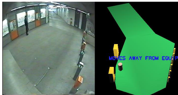
FIG. 6.14 – A gauche: une entrée du métro à Nuremberg à t_4 . A droite: un événement “person 1 moves away from an equipment” est détecté.
