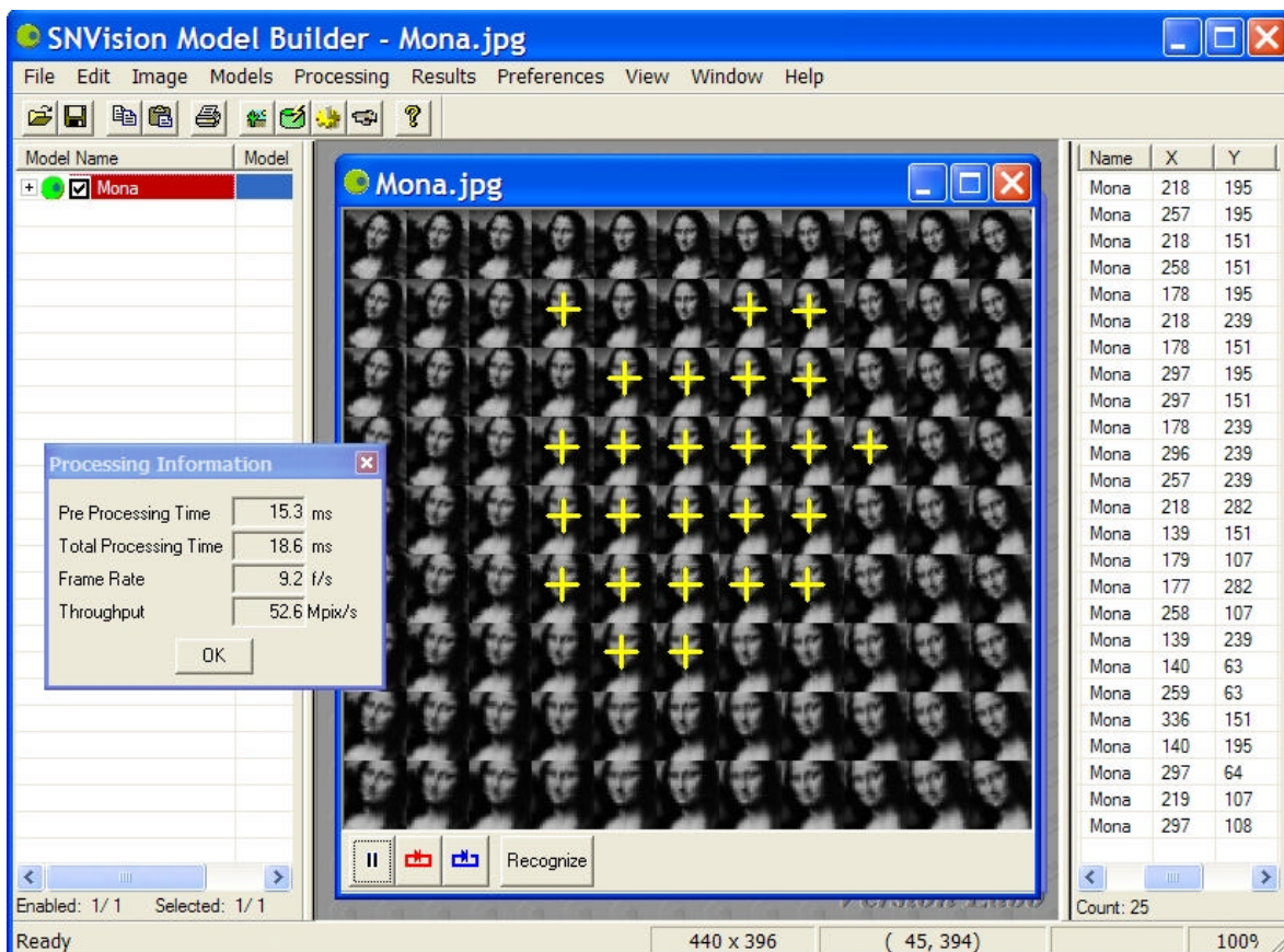
Figure 2 : Screen shot du logiciel SNVision Model Builder, illustrant qu'un même modèle capable de détecter 25 variations de la Joconde avec des variations d'environ \pm 10^\circ et \pm 10\% .
