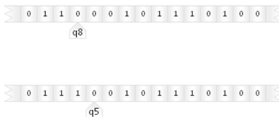
FIGURE A.1 – Exemple d’action. Si l’état est  $q8$  et le caractère lu est 0, alors écrire 1, se décaler à droite et passer dans l’état  $q5$ . La valeur de la fonction de transition  $\delta$  correspondant à cette entrée dans la table des actions est :  $\delta(q8, 0) = (q5, 1, \rightarrow)$ .
