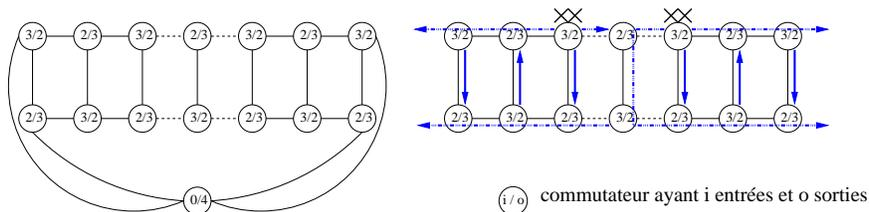
FIG. 5: Réseaux construits avec des commutateurs de degré 8 ( $r = 4$ ) tolérants 4 pannes et un exemple de routage pour un jeu de 4 pannes.
