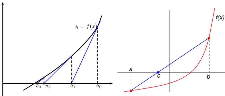
Figure 1: Méthode de Newton et méthode de la sécante. Normalement, on prend des valeurs initiales assez proches, contrairement à ce que suggère la figure.
