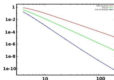
Advection d'une fonction sinus sur maillages cartésiens. Erreur schéma CENO, Erreur schéma V6, Erreur nouveau schéma.
