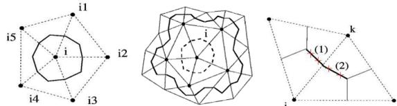
Construction d'une cellule  $C_i$ , de la molécule  $S_i$  centrée au nœud  $i$  et intégration numérique des flux.
