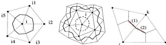
Sur chaque segment  $C_{ij}^{(1)}$  et  $C_{ij}^{(2)}$  une intégration numérique avec deux points de Gauss utilise des *solveurs de Riemann* :
