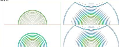
Schéma MUSCLV4 (haut), schéma CENO d'origine (bas), 500 itérations en temps (gauche) et 1000 itérations (droite), CFL=0.1.
