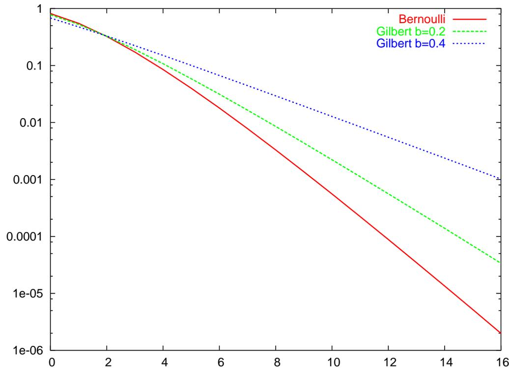
Probabilité de perte d'un bloc de taille  $k = 16$ , en fonction de  $h$  et de l'autocorrélation entre pertes (modèle de Gilbert).
