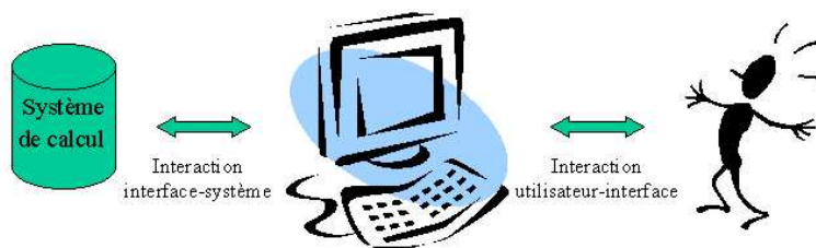
FIG. 3.7 – Deux niveaux d'interaction existent en FIGUE. L'utilisateur peut sélectionner des objets du document. La structure de ces objets est utilisée pour communiquer ensuite une requête à un système de calcul.
