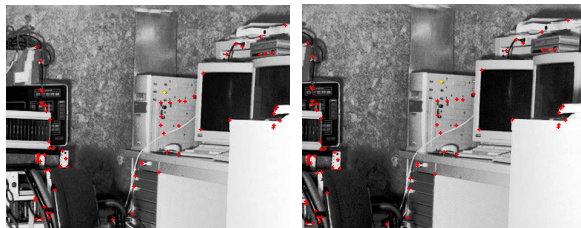
FIG. 9 – Mise en correspondance entre deux images où le changement d'échelle est de 1.2. Un déplacement de la caméra a été effectué entre les deux images.
