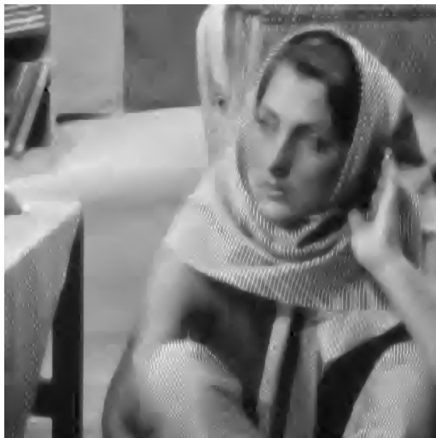
FIG. 5.12 – Image compressée avec notre algorithme (UVEA) (10% des coefficients pour u et v )
