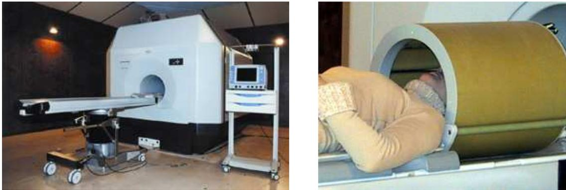
FIG. 2.12 – *IRM Bruker 3 Tesla du centre IRMf du CHU de la Timone à Marseille et antenne tête (système radio-fréquence) de type "cage d'oiseau". Extrait de <http://irmfmrs.free.fr/>*
