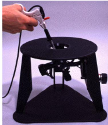
FIG. 4 – Un système à retour d'effort ayant l'aspect d'un instrument chirurgical (provenance Immersion Corporation [www.immerse.com](http://www.immerse.com))
