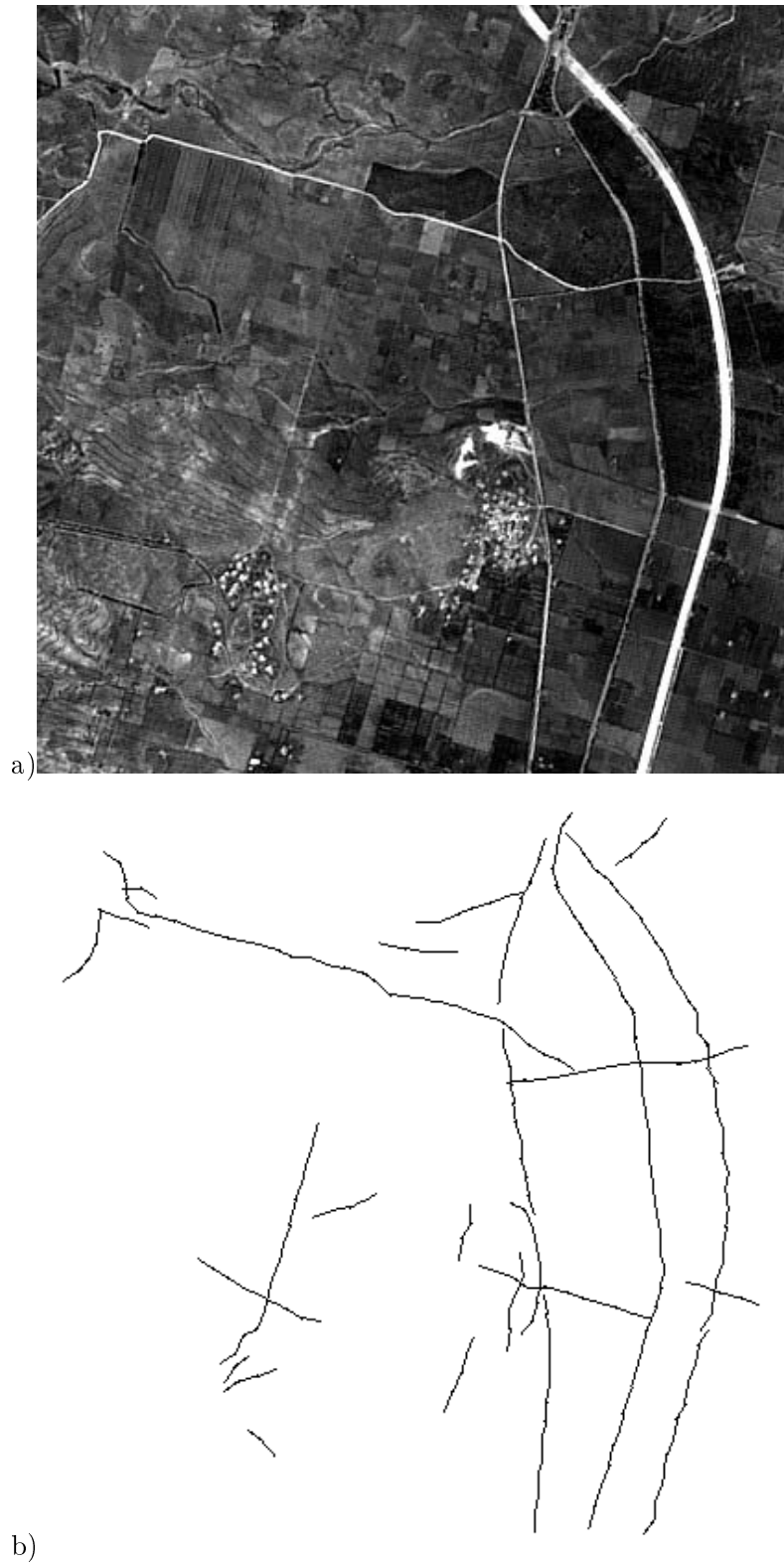
FIG. 6.10 – Extraction des routes : a) images SPOT T3 ; b) réseau routier détecté
