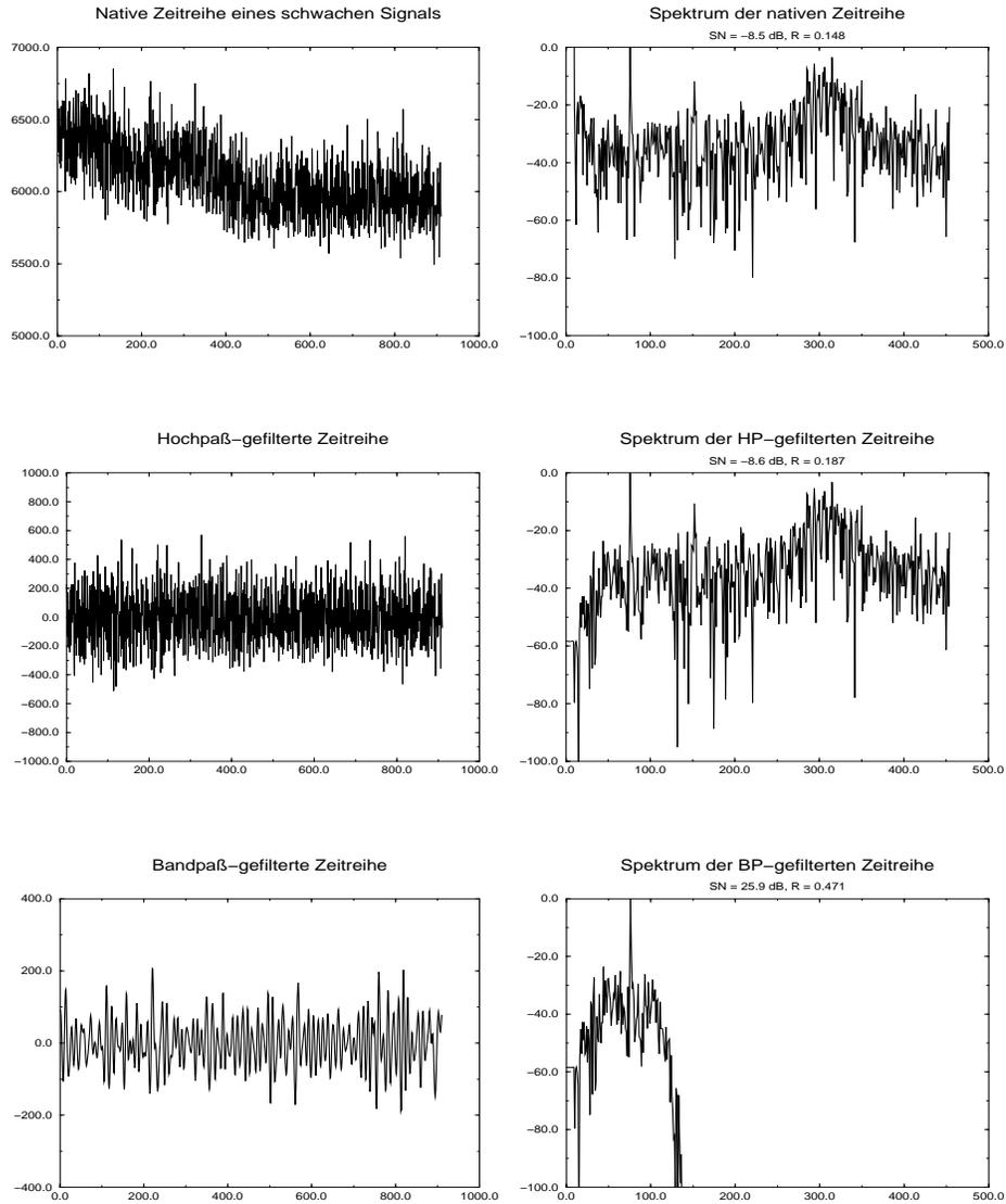
**Abb. 1.** Zeitreihen (links) und Spektren (rechts) eines Voxels mit schwacher funktioneller Aktivierung in nativer Form, nach Grundlinienkorrektur bzw. nach Bandpaßfilterung. Für die Spektren wurden zusätzlich das Signal-Rausch-Verhältnis (SN) und die Pearson-Korrelation (R) mit dem Stimulus (als box-car-waveform) angegeben.
